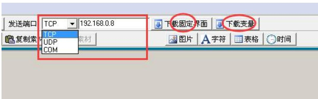
2.10.1 下载组态界面时需要选择下载端口为 TCP 端口，IP 地址是指 LED 工业屏的 IP 地址；
